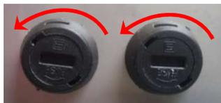
*Figura 22: Sostituzione dei fusibili*
