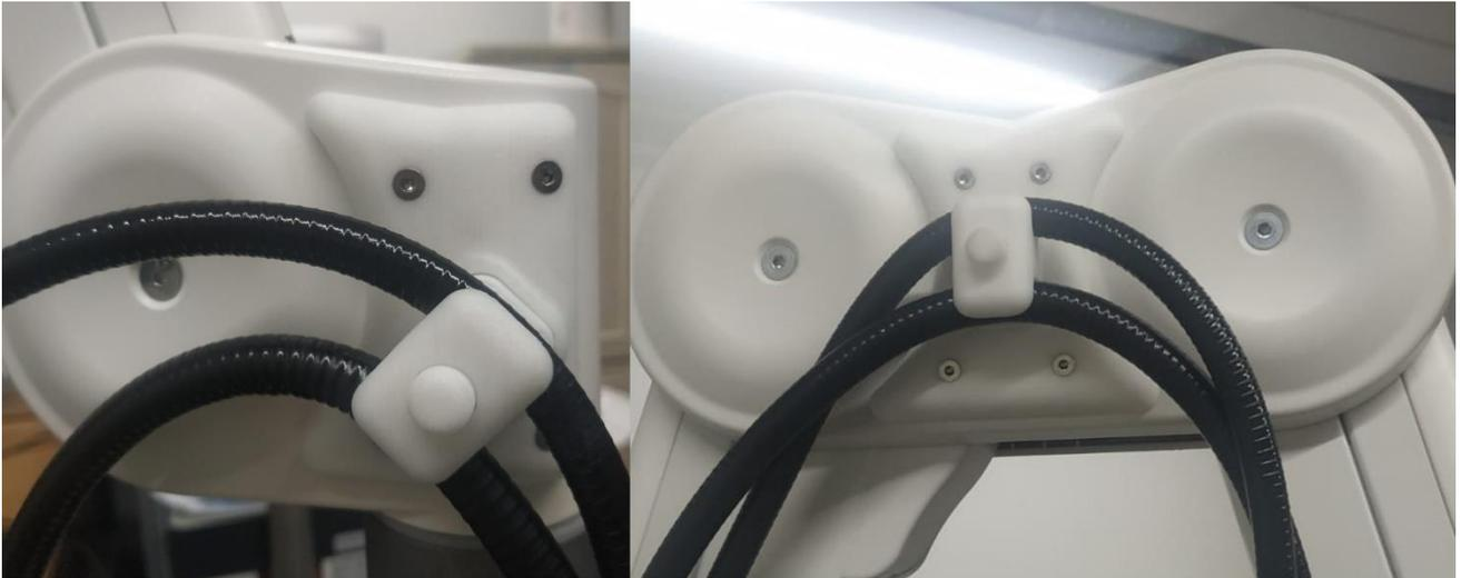
Figura 15: Cables asegurados en el brazo para cámara
