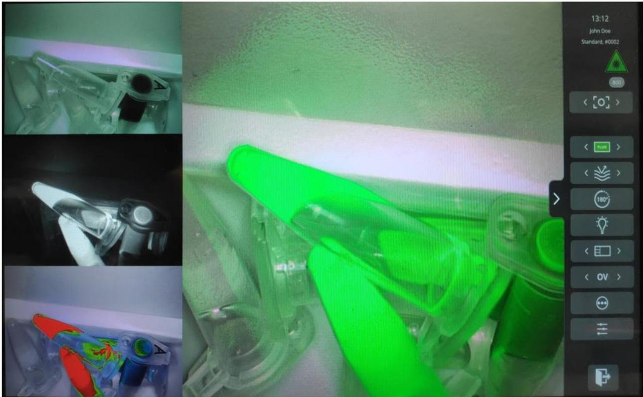
Figura 10: Vista del modo de cirugía (ICG). La imagen principal corresponde al modo Superposición (OV). A la izquierda, de arriba a abajo: modos RGB, NIR, GR.
