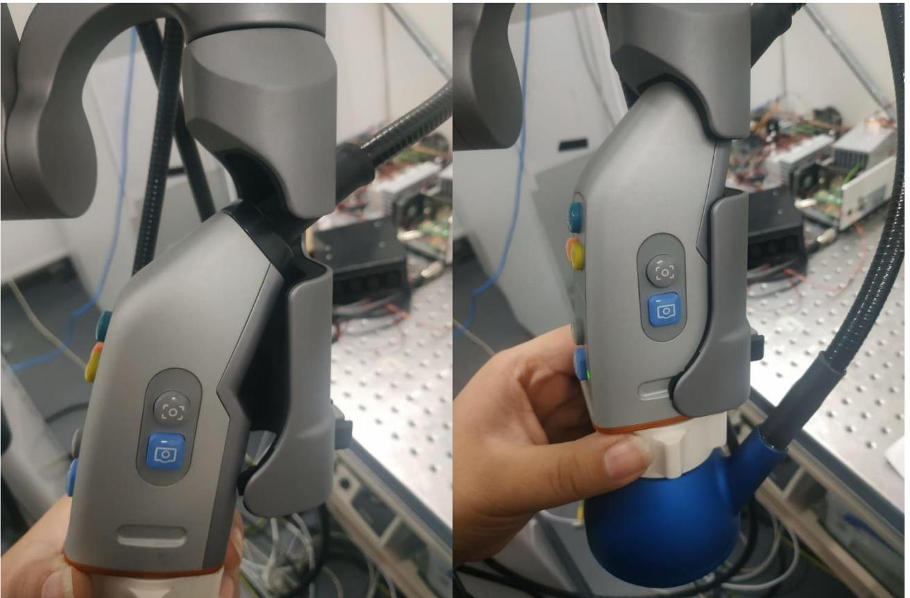
Figura 14: Cámara colocada en el sujetador del brazo
